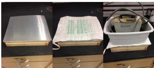
شکل ۵: ترتیب قرارگیری بخش‌های مختلف دستگاه برداشت کرم سفید. ۱- وزنه، ۲- منبع حرارتی (زرد رنگ)، ۳- صفحه آلومینیومی (قرمز)، ۴- عایق، ۵- دیواره‌های کناری چوبی، ۶- توری (چشمه ۲/۵ mm)، ۷- پایه‌های چوبی، ۸- صفحه پلکسی گلاس (پلاستیک شفاف) (Pompeo, 2017)
