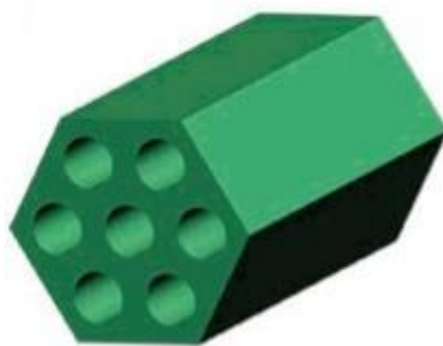
شکل ۶: ساختار شماتیک SBA-15
