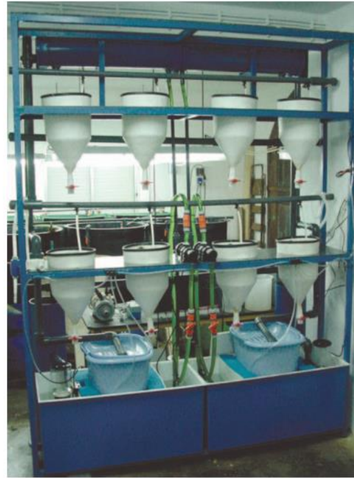
شکل ۶: طرحی از یک سیستم پرورش لارو و سیستم و نگهداری مولدین میگوی زینتی (da Rocha, 2017)
