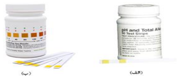
شکل ۶: معرف‌های شیمیایی برای اندازه‌گیری قلیائیت (الف) و سختی (ب)
