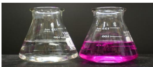
شکل ۷: تغییر رنگ معرف شیمیایی فنیل‌فتالین در اندازه‌گیری قلیائیت آب
