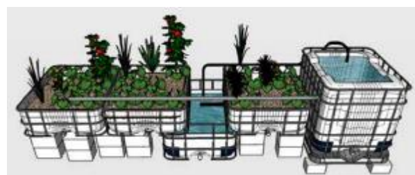
شکل ۱: طرحی شماتیک از یک واحد آکوابونیک خانگی (Somerville et al., 2014)
